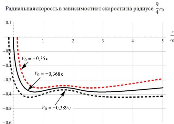
Рис. 6. Зависимости радиальной скорости пробной частицы от радиуса при различных значениях начальных скоростей (значения V_0 приведены к радиусу сшивки 2,25r_0 )
