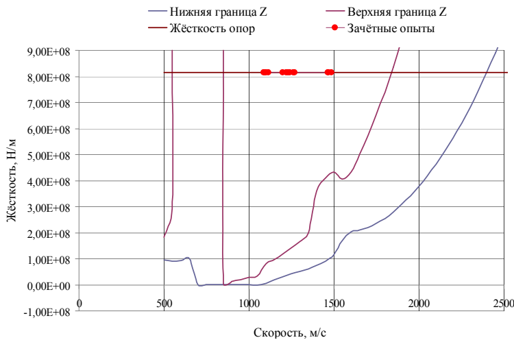
Рис. 6. Границы области неустойчивости поперечного движения в направлении оси Z осциллятора, моделирующего высокоскоростной объект ( M = 200 \text{ кг} , m = 6 \text{ кг} , \varepsilon = 300 \text{ Н}\cdot\text{с}\cdot\text{м}^{-1} )
