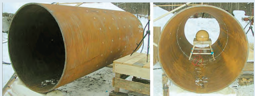
Образец трубы, подготовленный к взрывному испытанию, в двух видах
