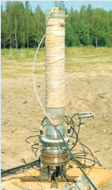
Трехэлементный дисковый ВМГ перед опытом
