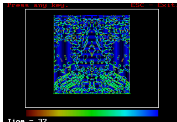
Рис. 2. Плотность воды \rho(r,z) , t = 33,7 мкс. Расчет с учетом поляризационных свойств воды
