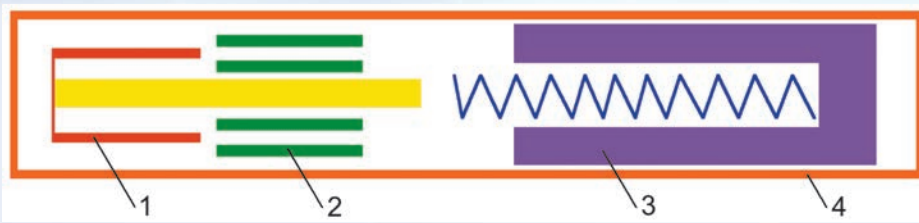
Схема нейтронного источника с электромагнитным приводом: 1 – титановый цилиндр с полонием-210; 2 – бериллиевая мишень; 3 – электромагнит; 4 – герметичный корпус
