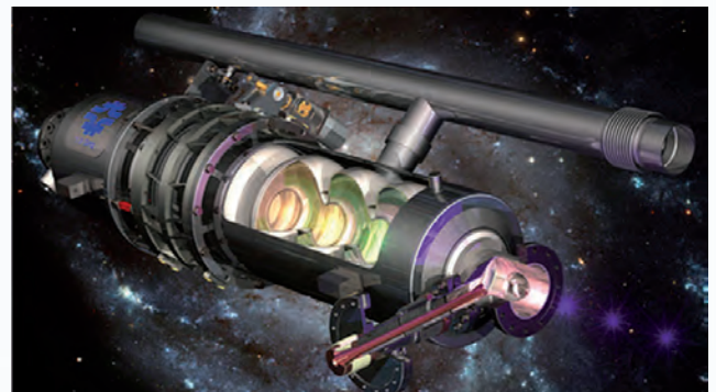
Рис. 15. Узел криомодуля коллайдера ILC
