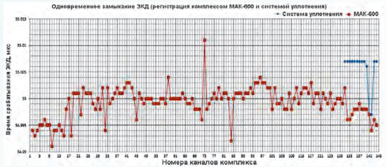
Рис. 20. Хронограмма разновременности срабатывания каналов во взрывном опыте
