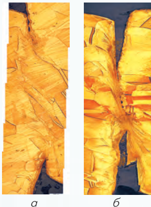
Рис. 6. Развитие микроструктуры локализованной деформации сдвига, полученной при разных длительностях нагружения: а – 72 мкс (начальная стадия, зерна начинают вытягиваться вдоль направления деформации); б – 140 мкс (развитая полоса сдвига)
