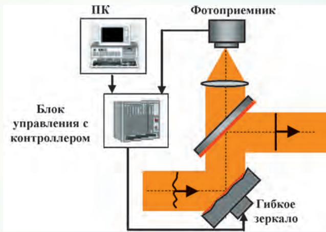
Схема адаптивной системы без ДВФ
