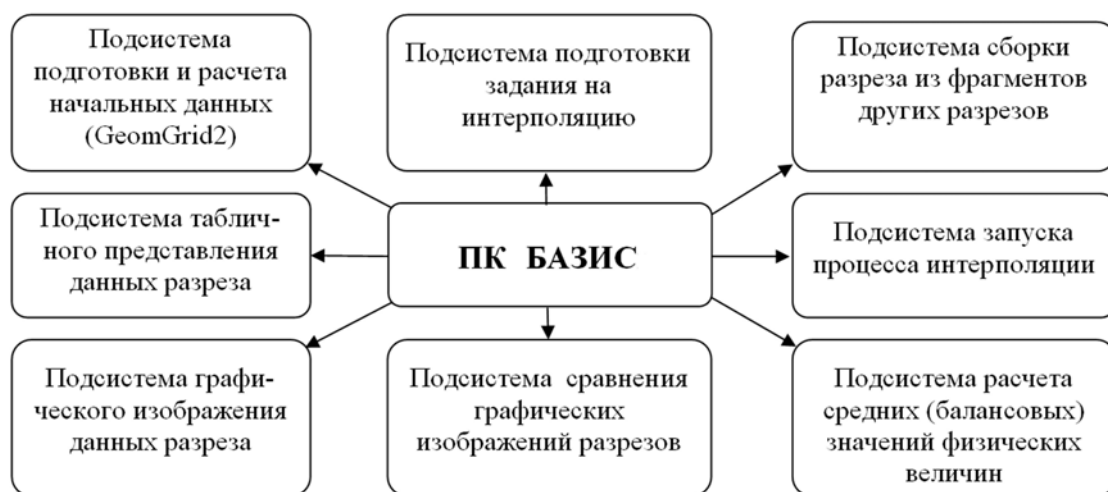
Рис. 1. Подсистемы ПК БАЗИС
