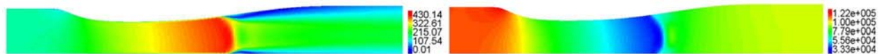
Рис. 16. Задача 3. Распределение скорости и статического давления в диффузоре для режима сильный скачок ; модель турбулентности SA
