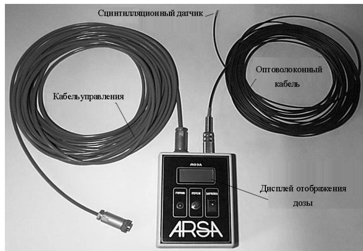
Рис. 6. Волоконно-оптический монитор-дозиметр, совмещенный с пультом управления ускорителя АРСА
