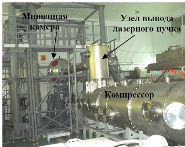
Рис. 6. Фото компрессора и мишенной камеры
