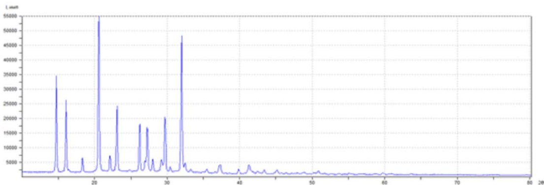
Рис. 6. Дифрактограмма образца октогена УВВ9.5
