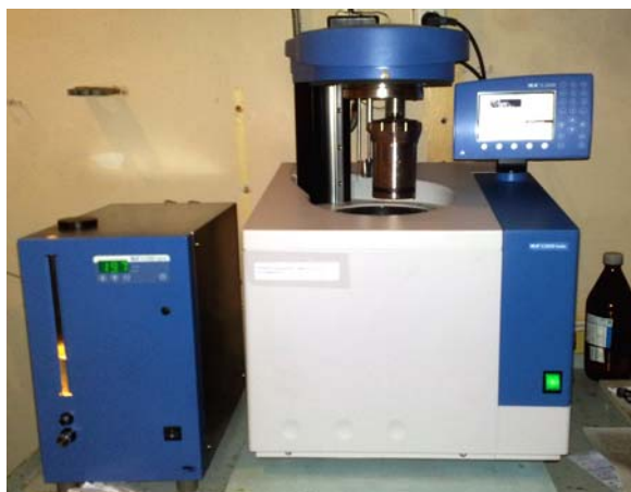
Рис. 1. Внешний вид калориметрической системы ИКА С2000 с калориметрической бомбой и термостатом
