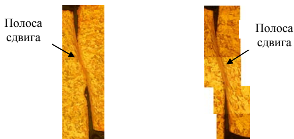
Рис. 5. Микроструктура зоны сдвига в меди М1 в состоянии поставки; ширина полосы локализованного сдвига 30 мкм (слева) и 40 мкм (справа) [10]
