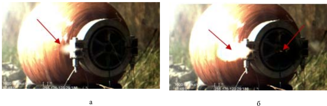
Рис. 7. Кадры скоростной видеосъемки испытания сферической ВЗК на различные моменты времени (стрелки указывают на места истечения газов): а – t = 1 мс, б – t = 2 мс
