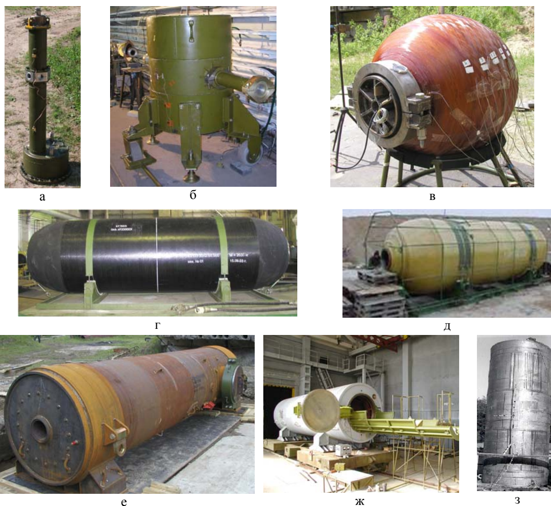
Рис. 2. ВЗК различного назначения: а – малогабаритная для проведения оптических и рентгенографических измерений: \varnothing_n = 0,42 м, L = 1,0 м, \varnothing_o = 0,1 м, M_k = 70 кг, m_{\text{ВВ}} = 0,015 кг ТЭ; б – для радиографии: \varnothing_n = 0,82 м, L = 1,1 м, \varnothing_o = 0,23 м, M_k = 980 кг, m_{\text{ВВ}} = 2,5 кг ТЭ; в – сферическая: \varnothing_n = 0,88 м, L = 0,95 м, \varnothing_o = 0,22 м, M_k = 470 кг, m_{\text{ВВ}} = 5,4 кг ТЭ; г – для аварийных боеприпасов: \varnothing_n = 0,99 м, L = 3,31 м, \varnothing_o = 0,43 м, M_k = 2000 кг, m_{\text{ВВ}} = 11,2 кг ТЭ, масса инертной упаковки боеприпаса – 40 кг; д – «Колба»: \varnothing_n = 2,66 м, L = 9,2 м, \varnothing_o = 0,55 м, M_k = 25 т, m_{\text{ВВ}} = 200 кг ТЭ; е – для радиографии: \varnothing_n = 1,42 м, L = 6,2 м, \varnothing_o = 0,65 м, M_k = 25 т, m_{\text{ВВ}} = 40 кг ТЭ; ж – для аварийных боеприпасов: \varnothing_n = 1,79 м, L = 6,5 м, \varnothing_o = 1,0 м, M_k = 25 т, m_{\text{ВВ}} = 60 кг ТЭ; з – из стали 12Х18Н10Т: \varnothing_n = 2,44 м, L = 5,6 м, \varnothing_o = 0,5 м, M_k = 20 т, m_{\text{ВВ}} = 100 кг ТЭ
