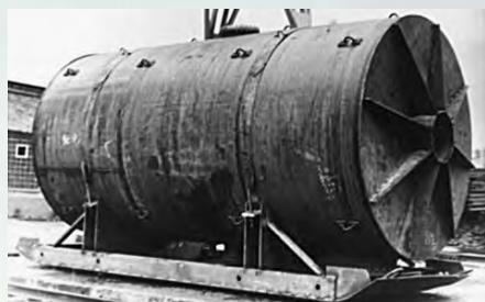
Рис. 12. Ампула для опыта РИР-1
