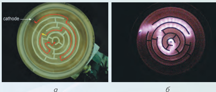
Рис. 8. Решение тлеющим разрядом лабиринта с потенциальным барьером: а – схема лабиринта, стрелками показан единственный путь, светлая стрелка – на участке с потенциальным барьером; б – свечение плазмы тлеющего разряда вдоль найденного пути
