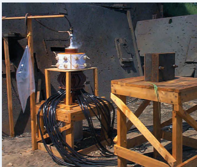
Рис. 1. Генератор сверхсильного магнитного поля МК-1 во время экспериментов по изоэнтропическому сжатию протия
