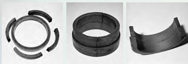
Рис. 8. Разрушенные топливные элементы реактора БР-1
