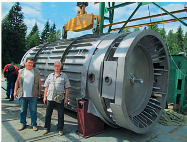
Сертификационные испытания транспортно-упаковочного комплекта для перевозки отработанного ядерного топлива АЭС
