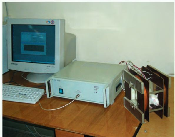
Рис. 7. Лабораторные генераторы «волновых форм», биполярного импульсного магнитного поля и образцы формируемых сигналов
