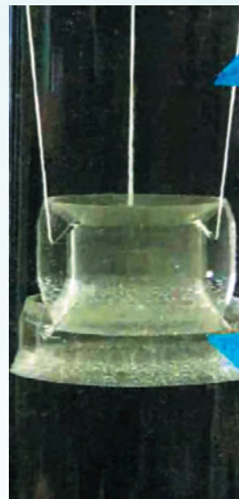
Модель осесимметричного ускорителя потока, подвешенного в канале цилиндрического стенда
