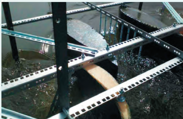
Основные элементы модели бесплотинной ГЭС: конфузор (сжимает и ускоряет втекающий поток) и диффузор (создает расширение течения для приема ускоренного потока)
