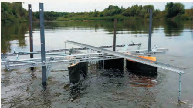
Модель бесплотинной ГЭС в экспериментах на реке Мокше
