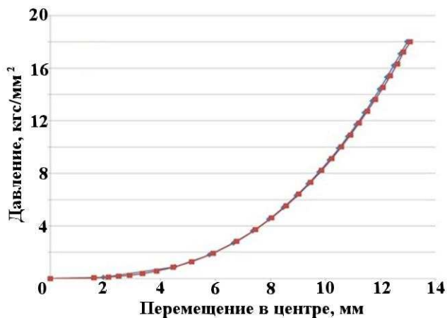
Рис. 13. Зависимость давления от перемещения в центре пластины: —♦— — аналитическое решение; —■— — расчет по ЛОГОС-Прочность
