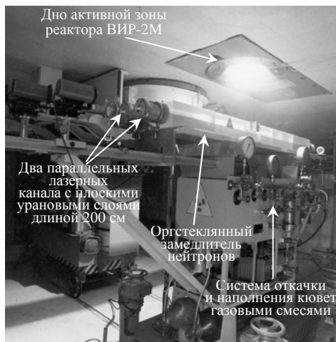
Рис. 4. Лазерная установка ЛУНА-2М под активной зоной реактора ВИР-2М
