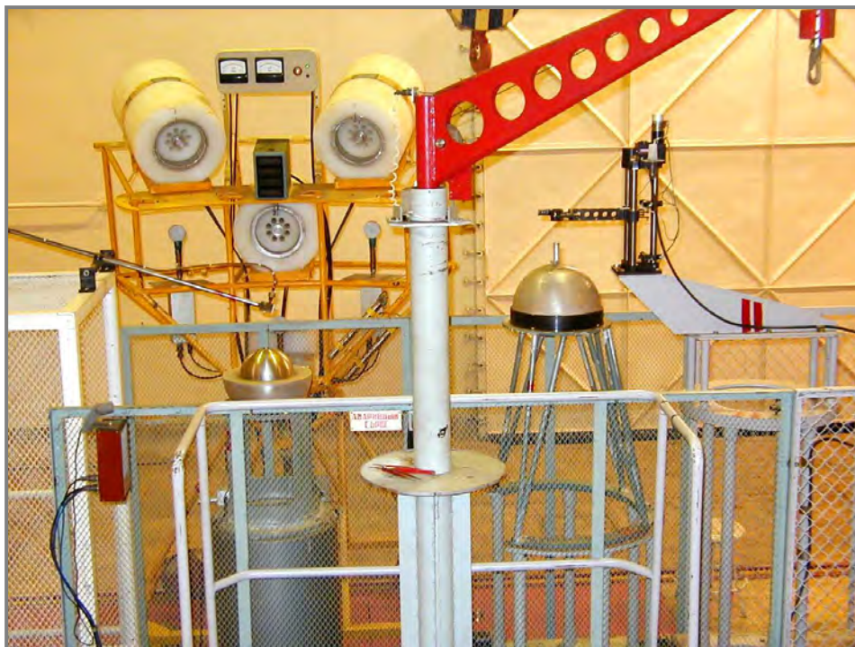
Рис. 2. Стенд ФКБН-2М с размножающей сборкой в экспериментальном зале
