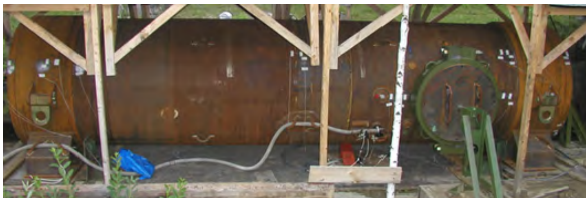
Рис. 9. ВЗК после нагружения взрывом заряда ВВ 55 кг ТЭ
