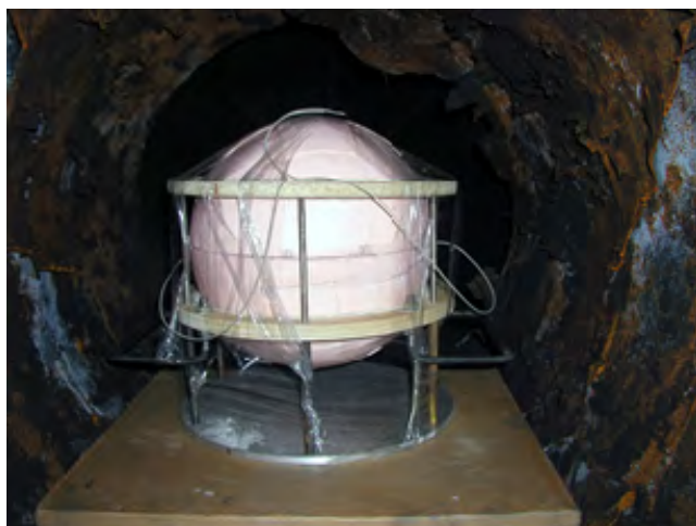
Рис. 8. Нагружающее устройство ~55 кг ТЭ, установленное в ВЗК
