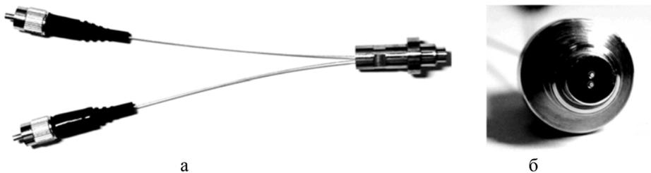
Рис. 1. Оптоволоконный зонд высокого давления: а – общий вид, б – торцевая поверхность
