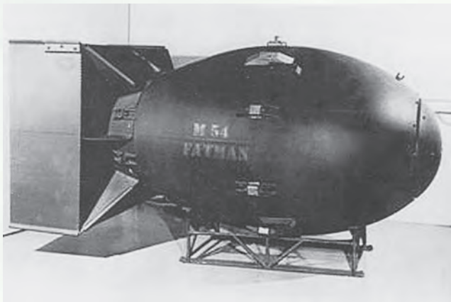
Американская бомба «Толстяк», основанная на принципе имплозии
