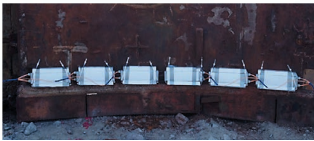
Рис. 5. Этапы резки «прочного» корпуса (сталь АК-29, 40 мм): а – первый этап, б – второй этап ( m_{ВВ} = 2 кг на погонный метр)
