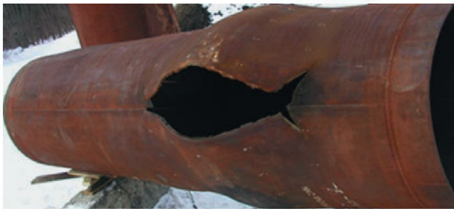
Рис. 2. Состояние трубы после испытания
