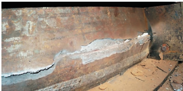
Рис. 6. Результаты резки «прочного» корпуса: а – со стороны реза, б – с тыльной стороны
