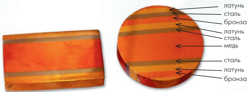
Рис. 8. Пример многослойной сварки взрывом слоев разных металлов
