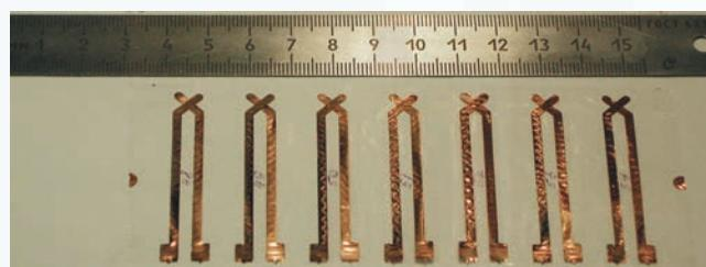
Рис. 3. ПВДФ-датчики давления
