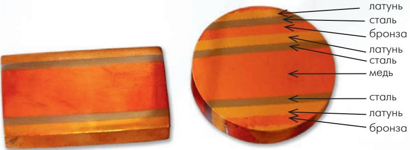
Рис. 8. Пример многослойной сварки взрывом слоев разных металлов
