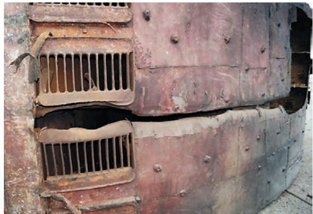
Рис. 7. Резка внешнего «легкого» корпуса шнуровым кумулятивным зарядом ( $m_{BB} = 0,5$  кг на погонный метр)
