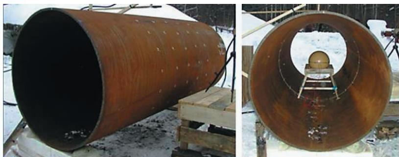
Рис. 1. Фотографии образца трубы, подготовленного к взрывному испытанию
