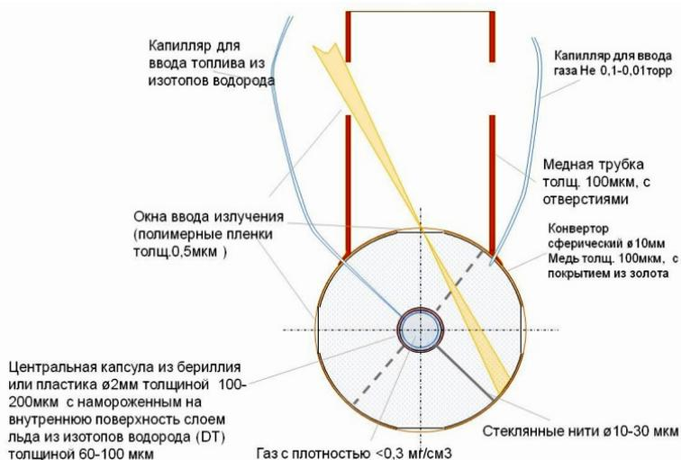
Рис. 6. Схематическое изображение криогенной мишени непрямого облучения для новой лазерной установки мегаджоульного уровня энергии
