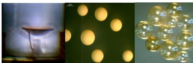
Рис. 8. Наращивание толщины стенки оболочек плазмохимическим методом
