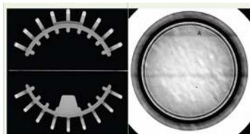
Рис. 5. Слой топлива во время процесса выравнивания. Рентгеновские изображения оболочки и топливного слоя, полученные с двух перпендикулярных направлений – через диагностическое отверстие с прорезями и через отверстие для ввода излучения [9]
