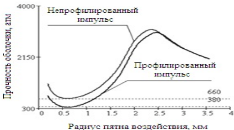
Рис. 3. Распределение давления срыва оболочки ВО для материала Сталь 20 толщиной 2 мм по радиусу лазерного пучка при воздействии непрофилированных и профилированных лазерных импульсов
