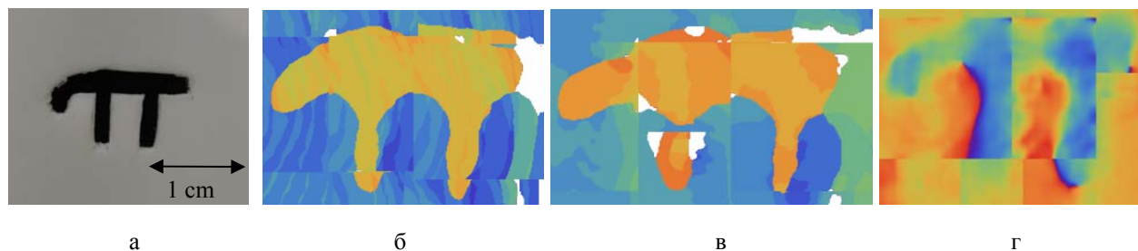
Рис. 2. Исследуемый образец (а) и его изображение, полученное методами времяпролетной (б), кросскорреляционной (в) и фазово-контрастной визуализации (г)
