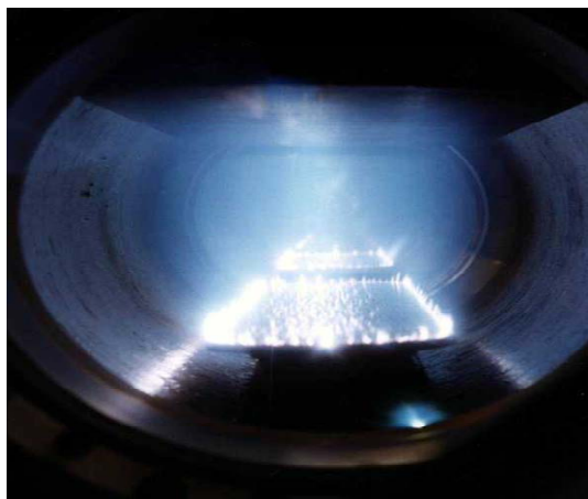
Рис. 4. Фотография СИОР в нецепном HF лазере, межэлектродное расстояние d = 27 см, разрядный объем \sim 60 л. Смесь SF_6:C_2H_6 = 20:1 при общем давлении 76 мм рт. ст.
