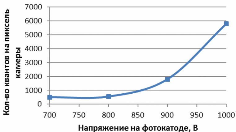
Рис. 10. Зависимость количества квантов, приходящих на пиксель камеры от напряжения на ЭОП
