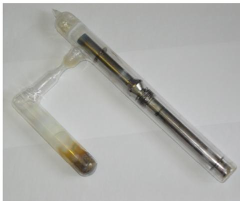
Рис. 11. Аппарат для разложения йодида скандия, аналогичный изображенному на рис. 10 и отличающийся «емкостью» со скандиевым геттером, которая размещена около «зоны разложения»
