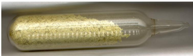
Рис. 4. Демонстрационный образец безводного йодида скандия, полученного по разработанной технологии
