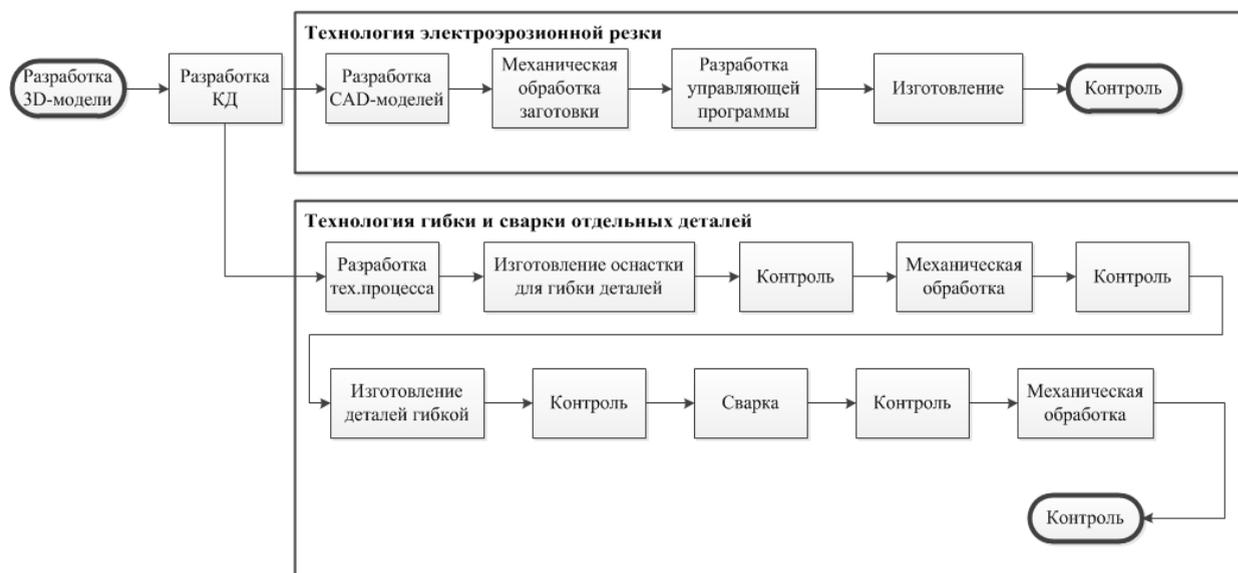
Рис. 2. Структурная схема этапов изготовления с помощью традиционных технологий
