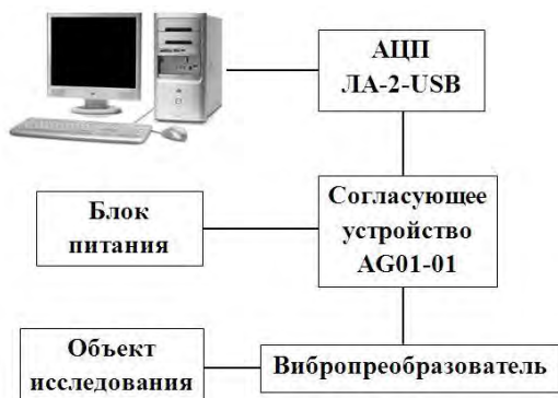
Рис. 2. Принципиальная схема мобильной установки регистрации сигналов АЭ
