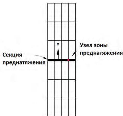
Рис. 2. Параметры секции преднатяжения
