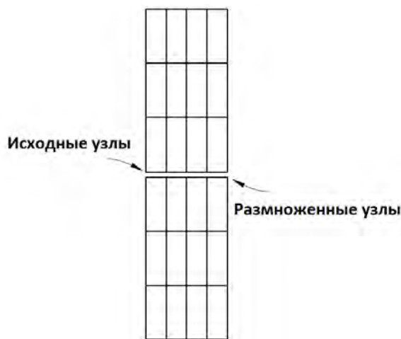
Рис. 3. Дублирование узлов поверхности преднатяжения
