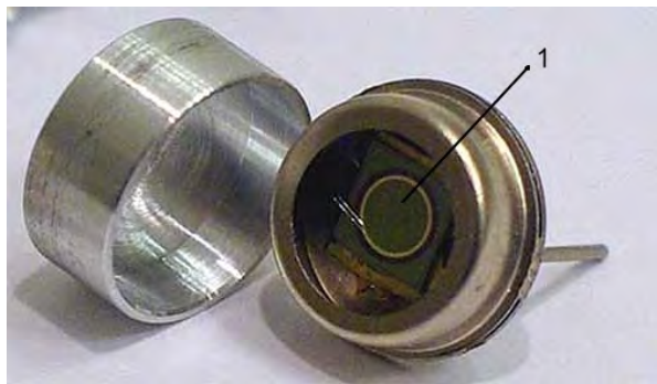
Рис. 1. Кремниевый фотодиод ФДУК-8УВС (с защитным колпаком для транспортировки и хранения): 1 – активная область фотодиода
