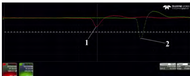
Рис. 11. Осциллограмма импульсов с горизонтальных емкостных датчиков в случае отклонения электронного пучка влево: 1 – правый датчик; 2 – левый датчик
