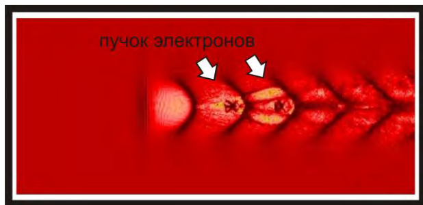
Рис. 5. Пространственная картина плотности электронов в нелинейной плазменной волне. Стрелкой на рисунке отмечены пучки ускоряемых электронов. Плазменная волна распространяется справа налево
