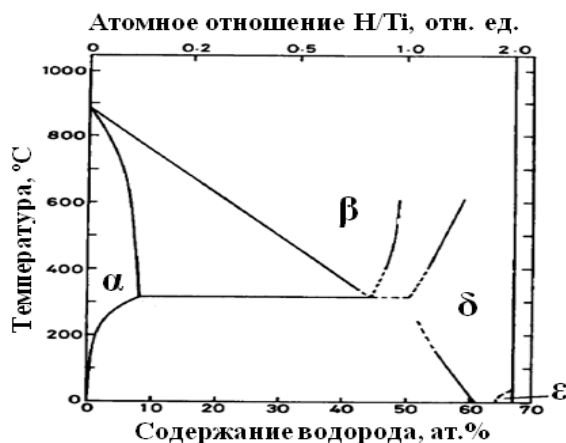
Рис. 1. Фазовая диаграмма системы титан-водород (0,1 МПа) [1]
