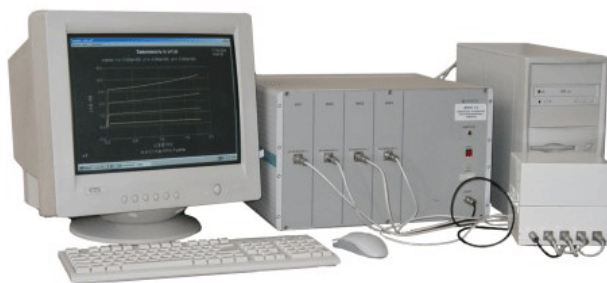
Рис. 3. Измеритель параметров полупроводниковых приборов ИППП-1
