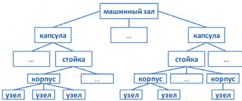
Рис. 5. Взаимосвязь компонентов вычислительного комплекса
