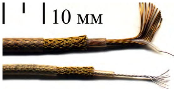
Рис. 1. Импульсные коаксиальные кабели КИМЭП-К (вверху) и КИМЭПМ (внизу)
