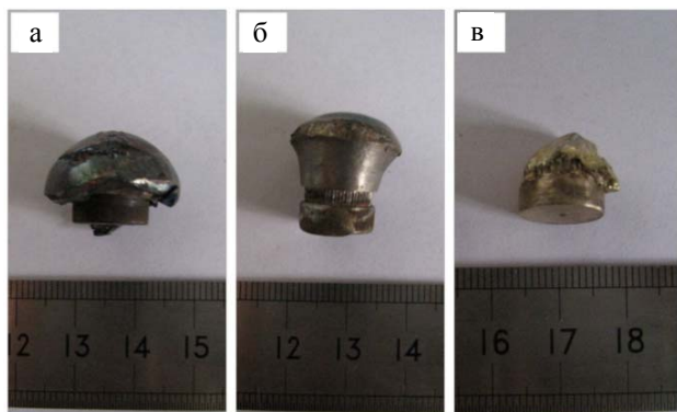
Рис. 13. Остатки ударников, извлеченные из мишеней: а – 35CrMnSiA; б – 90W–7Ni–3Fe; в – 80W–14Cu–6Zn
