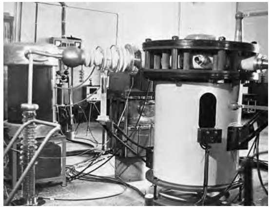
Вид инжектора на 500 кВ в бетатроне
