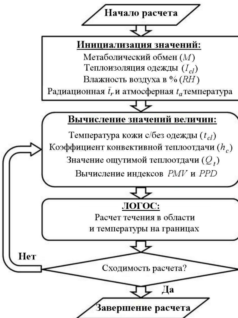
Рис. 1. Блок-схема алгоритма метода ТСМ
