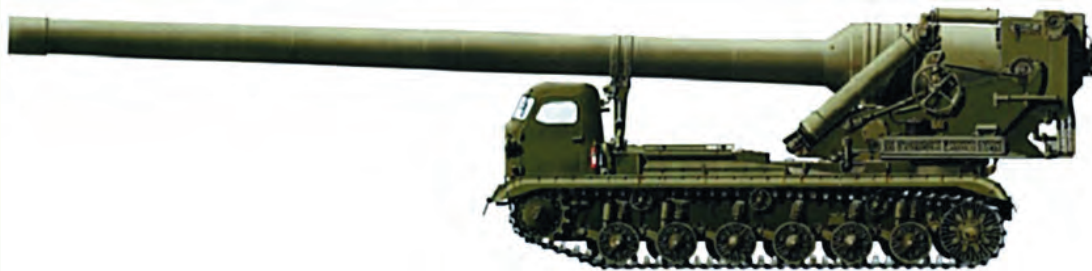
420-мм самоходное динамореактивное орудие С-103, конструктор В. Г. Грабин
