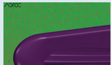
Построение поверхностной сетки на выделенных границах
