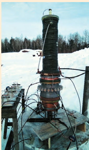
Дисковый взрывомагнитный генератор малого класса перед подрывом
